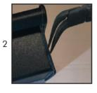
Um eine feste Verbindung zu erhalten, wird der Falz geschlossen. Zur Vorbeugung von Kratzern empfehlen wir die Falzzange mit einem Klebeband abzukleben.
