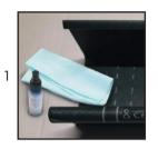
Klebebereich vor dem Reinigen anschleifen. Reinigen der Klebestellen mit dem haushaut-Haftreiniger empfohlen (im haushaut-Klebeset enthalten).
