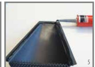
5. Kleberaube auf den Klebeflansch der Turbohaube auftragen (Kleberaube Durchmesser von min. 10-15 mm).
