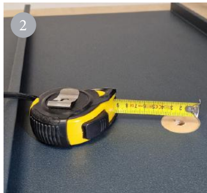
Bohrloch sollte min. 4cm Durchmesser haben!
