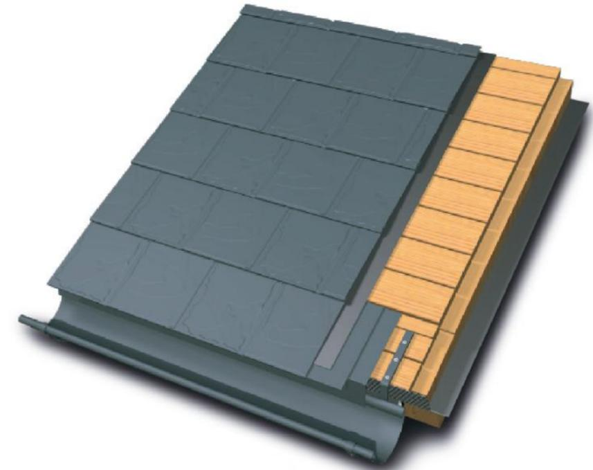
DETAIL PULTDACHABSCHLUSS HINTERLÜFTET
