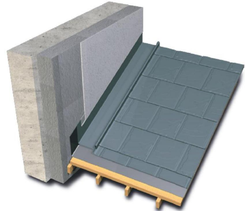
DETAIL SEITLICHER WANDANSCHLUSS MIT KAPPLEISTE
