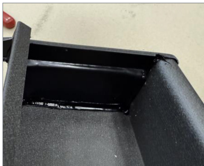
Um eine feste Verbindung herzustellen, wird der Falz mit einer Zange geschlossen. Zur Vermeidung von Kratzern, empfehlen wir das Werkzeug abzukleben oder das Reinigungstuch dazwischen zu legen.
