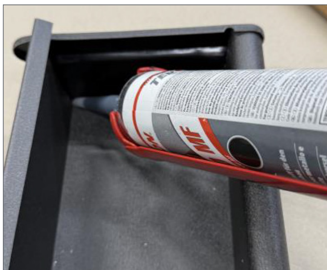
Anschließend wird der Endboden von innen wasserdicht versiegelt
