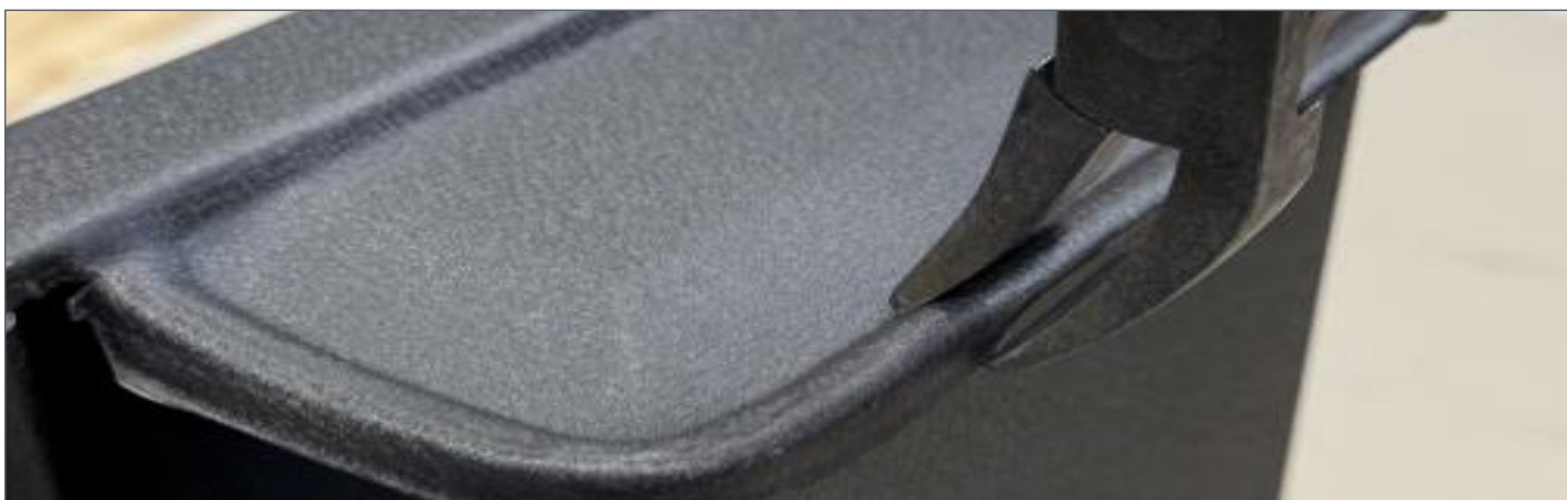
Um eine feste Verbindung herzustellen, wird der Falz mit einer Zange geschlossen. Zur Vermeidung von Kratzern, empfehlen wir das Werkzeug abzukleben oder das Reinigungstuch dazwischen zu legen.
